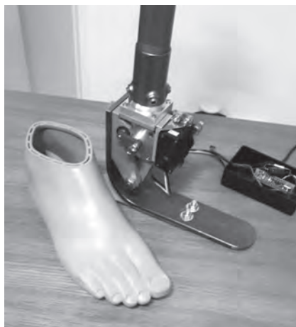
Рис. 8. Искусственная стопа со следящим приводом тыльного сгибания
