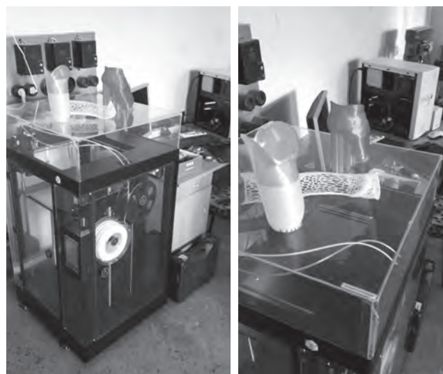
Рис. 15. 3D-принтер, обеспечивающий изготовление приёмных гильз протезов по сканированной модели культи, и образцы продукции
