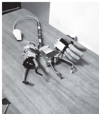
Рис. 12. Сменные функциональные захваты и сменная искусственная кисть с унифицированным стыковочным узлом
